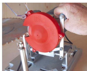
Poussez sur le levier du bloc-moteur pour faire pénétrer la meule le long de la face de la dent à affûter.
