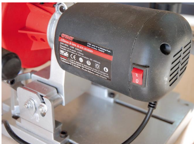
Le bloc-moteur peut être déplacé d'avant en arrière sur sa plaque de fixation.
