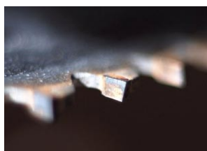
La face de la meule ne travaille pas parallèlement, le réglage est mauvais et doit être modifié.
