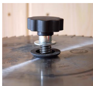
Le dispositif porte-lame s'adapte à toutes les dimensions d'alésage.
