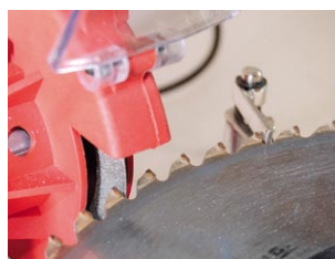
La face de la meule doit toujours être réglée parallèlement à celle de la dent.
