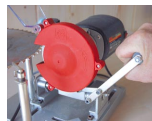
Une fois la dent affûtée, retirez le bloc-moteur vers l'arrière.
